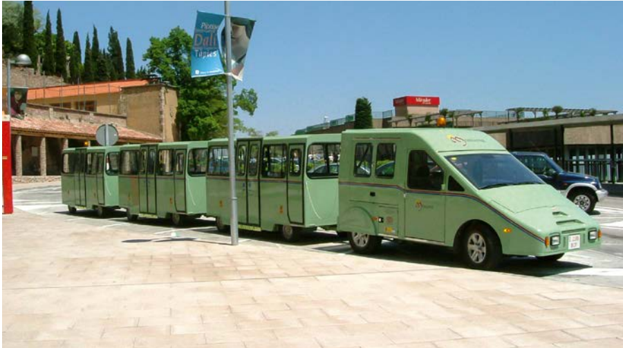
Abbildung 37: Gleislose Parkplatzbahn (Quelle: F. Aragall)
